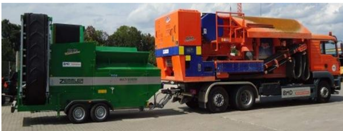
Figura 45: Exemplo de usina de reciclagem móvel de resíduos da construção civil – URM-RCC.
