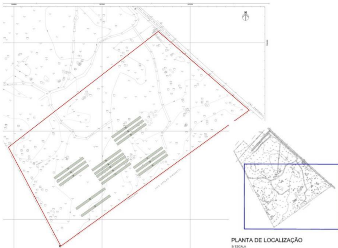
Figura 61: Localização das valas a serem implantadas. Fonte: PLANO DE ENCERRAMENTO - PMAG 060320.
