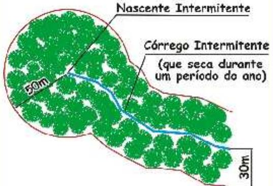
O diagrama mostra uma nascente intermitente (representada por um círculo verde) e um córrego intermitente (representado por uma linha azul). Uma linha vermelha indica a Área de Preservação Permanente (APP) ao redor da nascente, com um raio de 50 metros. Outra linha vermelha indica a APP ao longo do curso do córrego, com uma largura de 30 metros em cada margem. O córrego é rotulado como 'Córrego Intermitente (que seca durante um período do ano)'.
